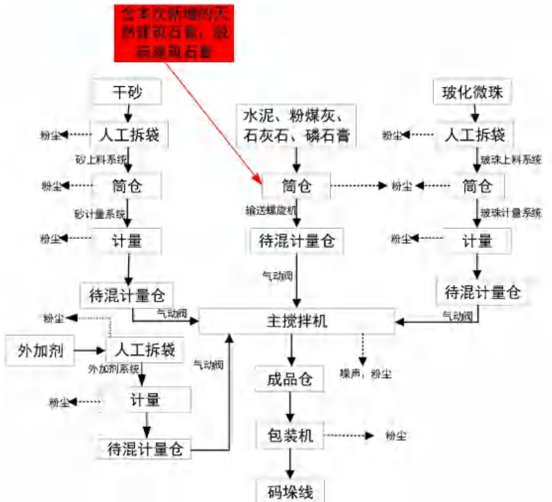
图2-4 石膏砂浆生产工艺流程及产污环节图
