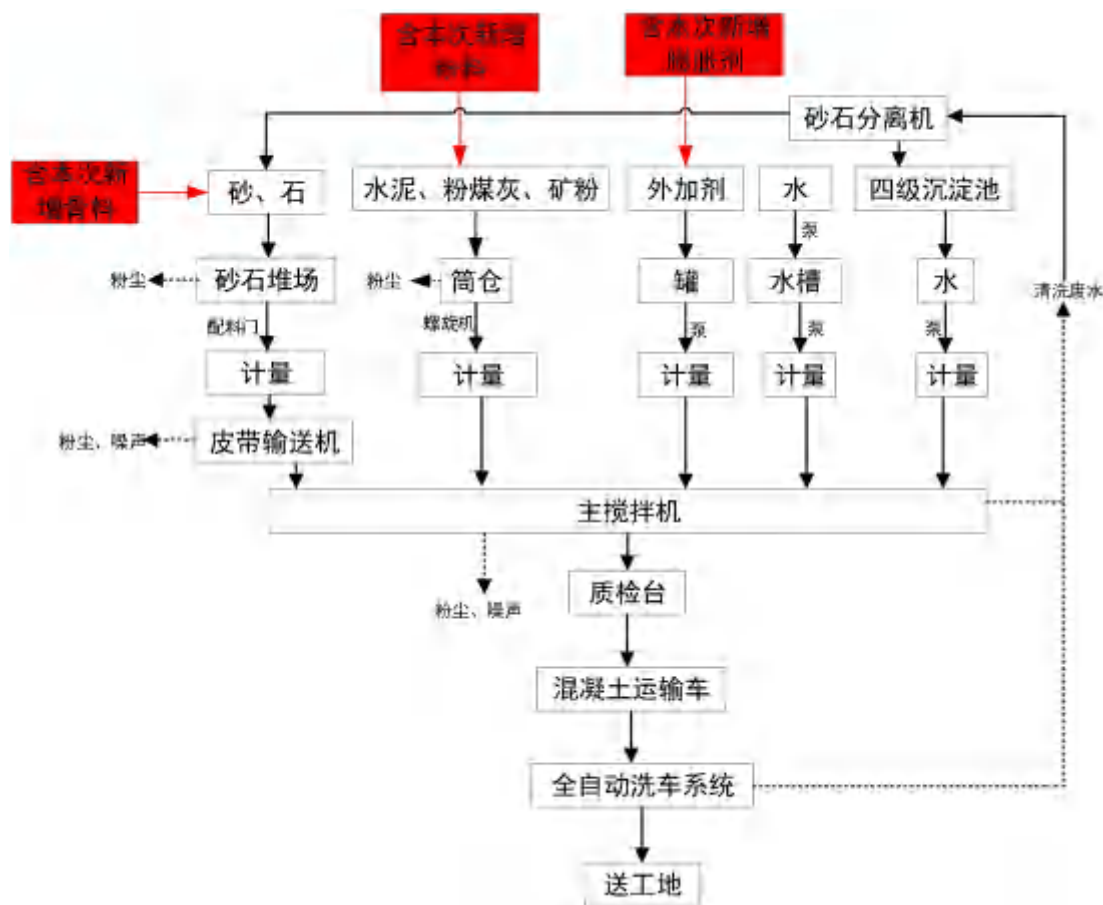
图2-2 商品混凝土生产工艺流程及产污环节图
