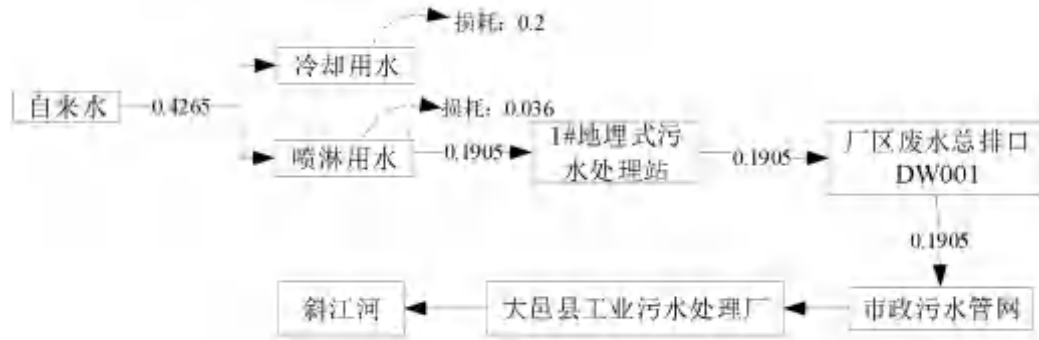
图 2-1 本项目水平衡图（单位：m 3 /d）
